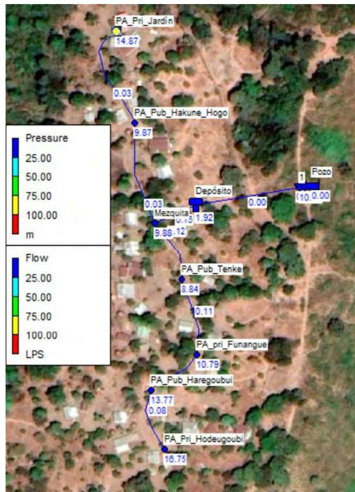
Figura 109 – Simulación de presión y velocidad de agua a las 13h00 en sistema de Pellel en EPANET.
